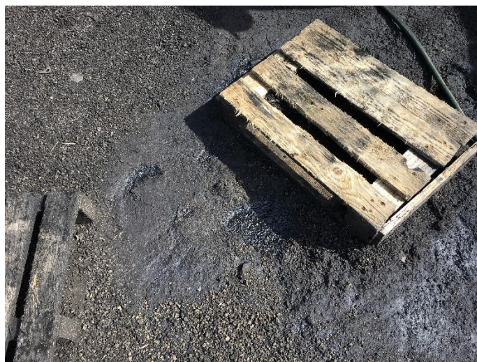
Foto 2 – Solo contaminado com hidrocarbonetos.
