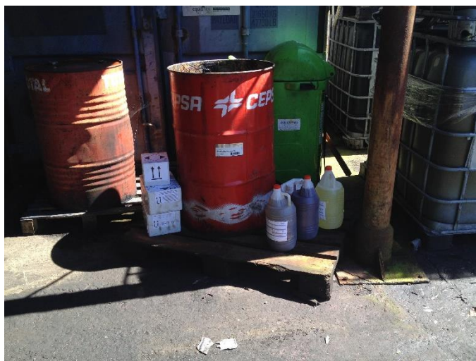
Foto 4 – Resíduos perigosos juntamente com resíduos não perigosos, no exterior e sem bacia de retenção.
