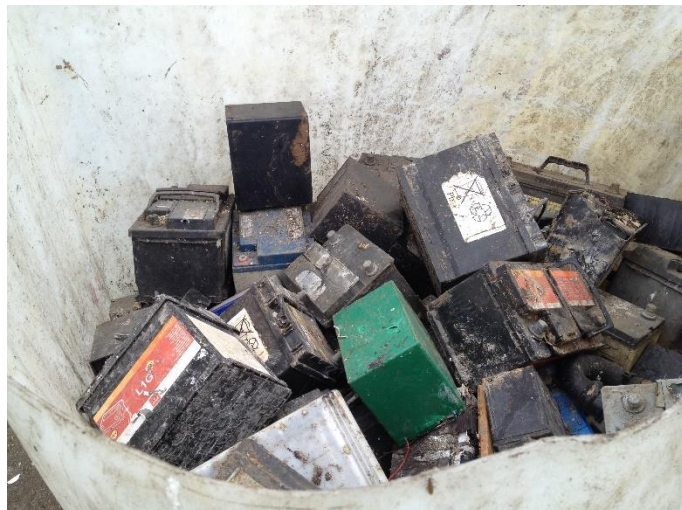
Foto 12 – Armazenagem de baterias/acumuladores ao ar livre e amontoados (não estão na posição vertical, com as aberturas voltadas para cima).
