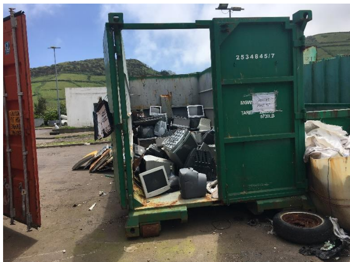
Foto 7 – REEE armazenados no exterior, alguns contendo componentes perigosos.
