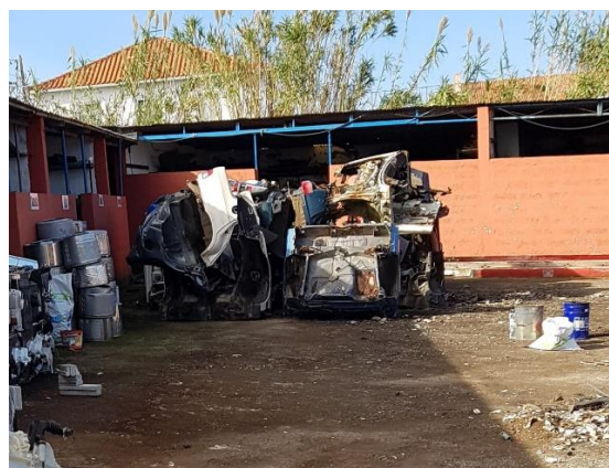
Figuras 22 e 23: Componentes, materiais retirados de VFV e frações resultantes da fragmentação, sem qualquer proteção contra a chuva e vento, sem superfície impermeável e sem sistema de recolha e tratamento de águas pluviais e de derramamentos.
