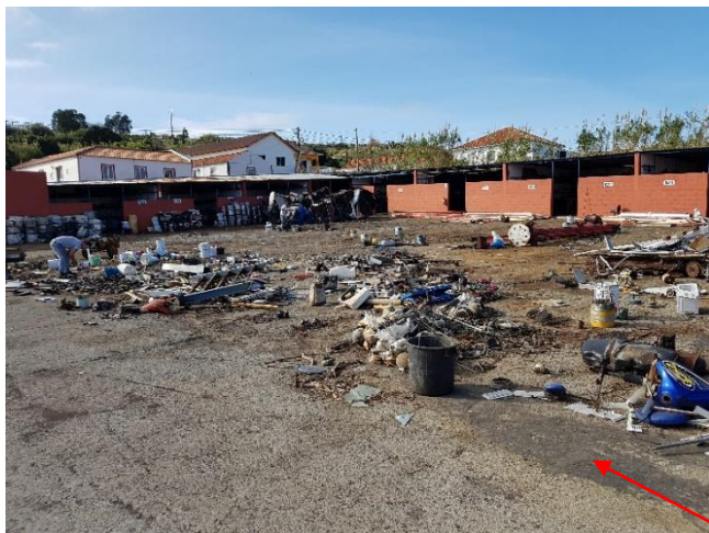
Figuras 2 e 3: Triagem e tratamento de resíduos (perigosos e não perigosos) realizada ao ar livre, em zona não coberta, com o pavimento não impermeabilizado e bastante danificado, sendo visíveis derrames de óleos e outros resíduos líquidos , que se infiltram no solo.
