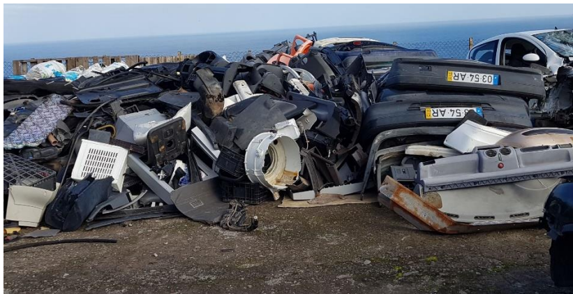
Figuras 20 e 21: Componentes, materiais retirados de VFV e frações resultantes da fragmentação (misturados com outros resíduos de plástico e REEE) em zona não coberta, sem superfície impermeável e sem sistema de recolha e tratamento de águas pluviais e de derramamentos.
