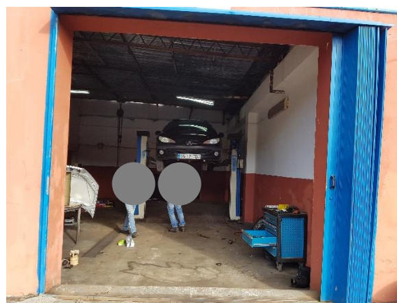
Figuras 16 e 17: Zona identificada para desmantelamento de VFV, equipada com sistema de recolha e tratamento de águas de limpeza e de derramamentos e com câmara de retenção de hidrocarbonetos (no entanto, o desmantelamento é realizado na rua).
