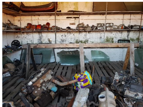
Figuras 24 e 25: Componentes, materiais retirados de VFV e frações resultantes da fragmentação, armazenados em baias, sem sistema de recolha e tratamento de águas de limpeza e de derramamentos.
