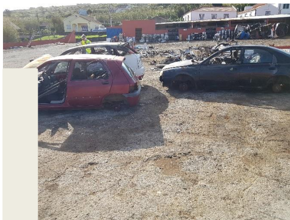
Figuras 18 e 19: Zona exterior onde os VFV são desmantelados, sem piso impermeabilizado e sem sistema de recolha e tratamento de águas pluviais e de derramamentos e sem ligação a decantadores e separadores de óleos e gorduras.
