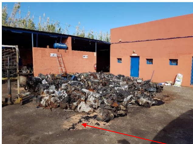
Figuras 4 e 5: Triagem e armazenagem de resíduos retirados de VFV, com componentes perigosos ou contaminados por substâncias perigosas, em zona não coberta, sem qualquer proteção contra a chuva e vento, sem superfície impermeável e sem sistema de recolha e tratamento de águas residuais e de derramamentos, sendo visíveis derrames de óleo que se infiltram no solo.
