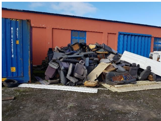
Figuras 20 e 21: Componentes, materiais retirados de VFV e frações resultantes da fragmentação (misturados com outros resíduos de plástico e REEE) em zona não coberta, sem superfície impermeável e sem sistema de recolha e tratamento de águas pluviais e de derramamentos.
