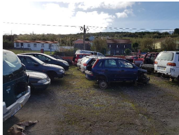
Figuras 14 e 15: Zona de armazenagem de VFV, não impermeabilizada e com o piso bastante danificado, não se encontrando dotada de sistema de recolha e tratamento de águas pluviais e de derramamentos com ligação a decantadores e separadores de óleos e gorduras.
