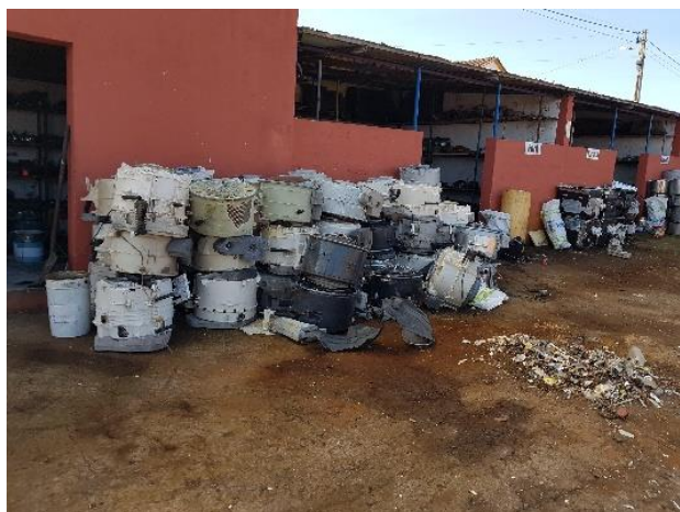
Figuras 9 e 10: REEE sobre superfície não impermeável, nem com cobertura à prova de intempéries, nem equipada com sistemas de recolha e drenagem de derramamentos com ligação decantadores e purificadores-desengorduradores.
