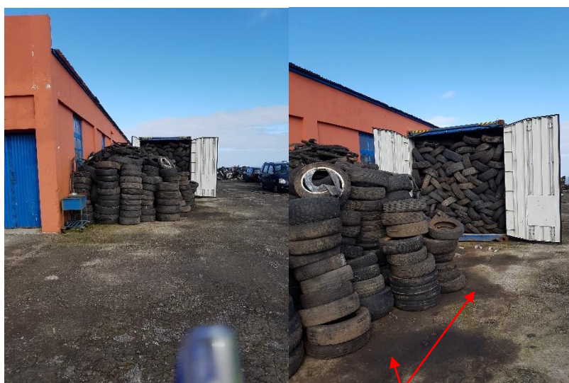
Figuras 7 e 8: Armazenagem de pneus com vestígios de óleo no pavimento não impermeabilizado, com consequente infiltração no solo.
