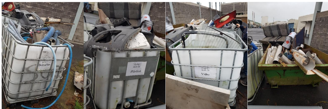
Figuras 2, 3, 4 e 5: Contentores de armazenagem de resíduos no exterior, sem estarem cobertos ou abrigados da chuva.
