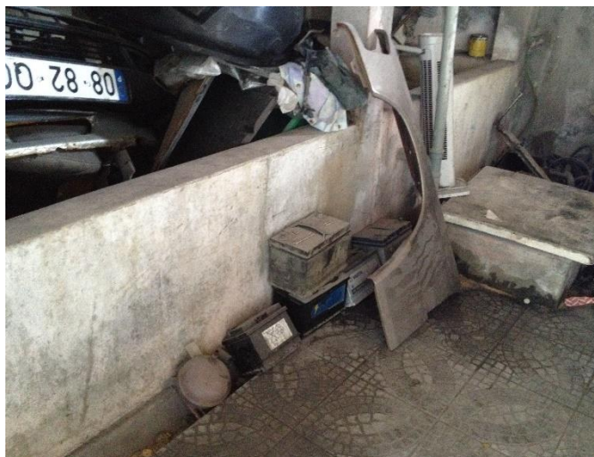
Foto 6 – Baterias (acumuladores) usadas armazenadas no chão da oficina.
