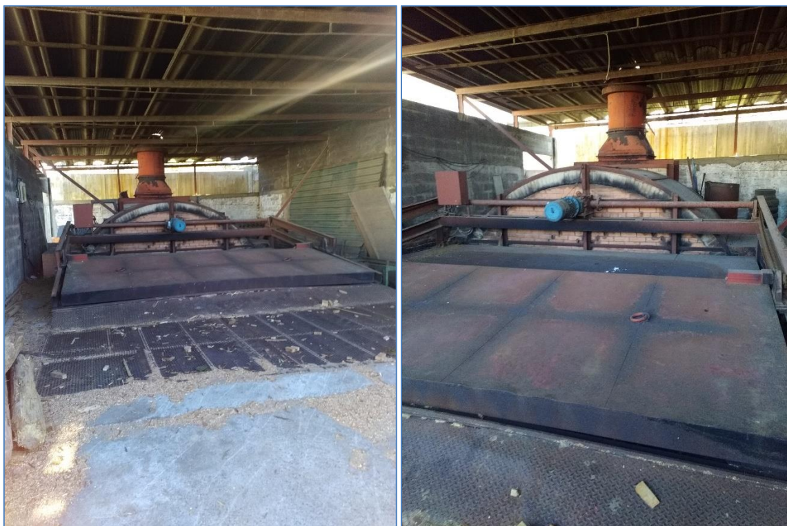
Figura 2.2: Fornalha para queima de resíduos de madeira.
