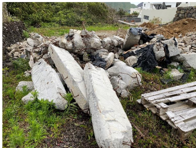
Foto 6 – Betão contendo ferro de armaduras, paletes e plásticos.
