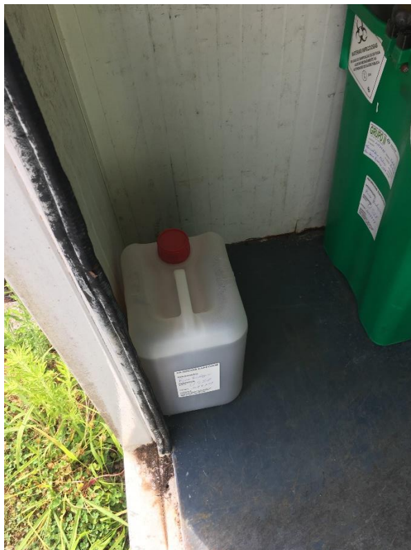
Foto 8 – Resíduos líquidos armazenados em recipientes sem parede dupla ou bacia de retenção.
