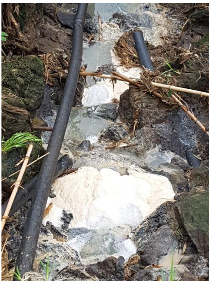
Figuras 5 e 6: Massas de cor brancas na água da ribeira que recebe o efluente da ETAR.
