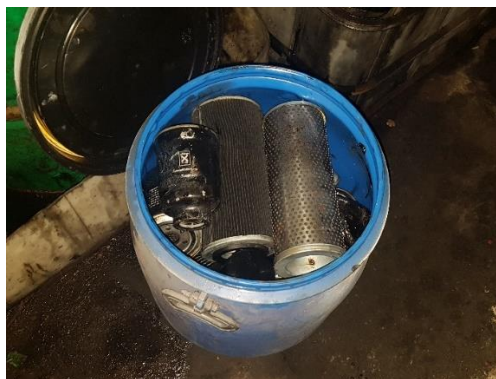
Figuras 15 e 16: Filtros de óleo e outro material filtrante contaminado por substâncias perigosas.
