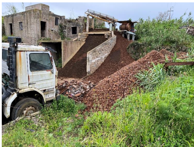
Foto 2 – Britadeira onde são britados os RCD (entulhos) para reincorporação em obra.
