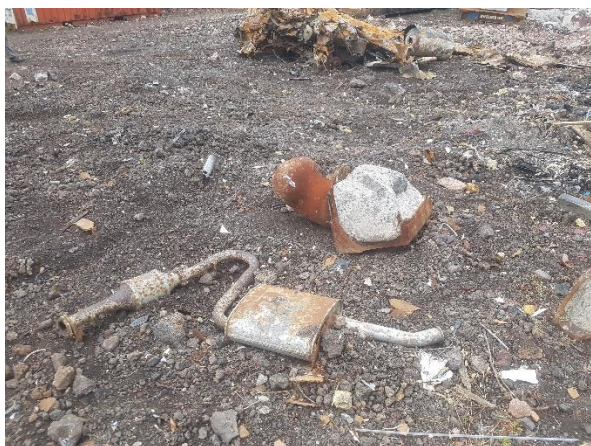
Figuras 56 e 57: componentes de viaturas, sucata e fragmentos de resíduos diversos incorporados no solo (plásticos, metais, RCD, entre outros).
