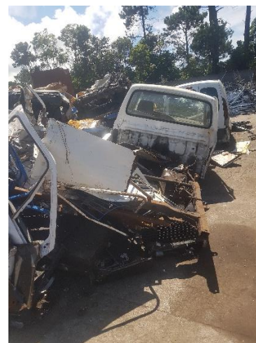
Figuras 36 e 37: mistura de resíduos (sucata diversa, metais, cabos, pneus e VFV, alguns esmagados com componentes no seu interior: bancos, vidros, tablier, volante, caixa de velocidades, jantes, recipientes de líquidos, entre outros), sendo visível a carrinha Renault branca, matrícula 95-92-SR, indiciando que a mesma irá ser compactada, sem que tenha sido devidamente despoluída e objeto de tratamento a fim de promover a reutilização e reciclagem.
