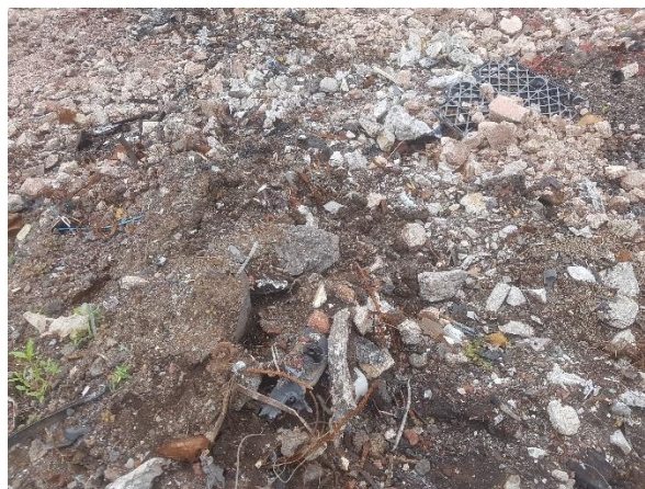
Figuras 56 e 57: componentes de viaturas, sucata e fragmentos de resíduos diversos incorporados no solo (plásticos, metais, RCD, entre outros).
