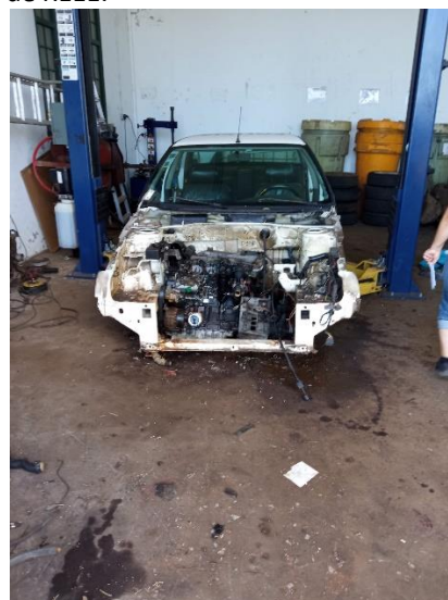
Figuras 4 e 5: zona de tratamento de VFV, sem sistema de recolha e tratamento de águas pluviais, águas de limpeza e de derramamentos nem dotada de decantadores ou separadores de óleos e gorduras.
