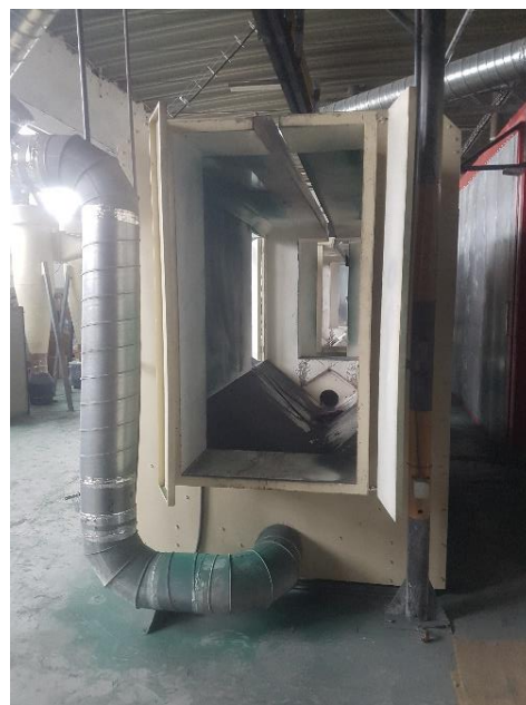
Figuras 7 e 8: cabine de pintura e respetivo exaustor com vestígios de tinta verde.
