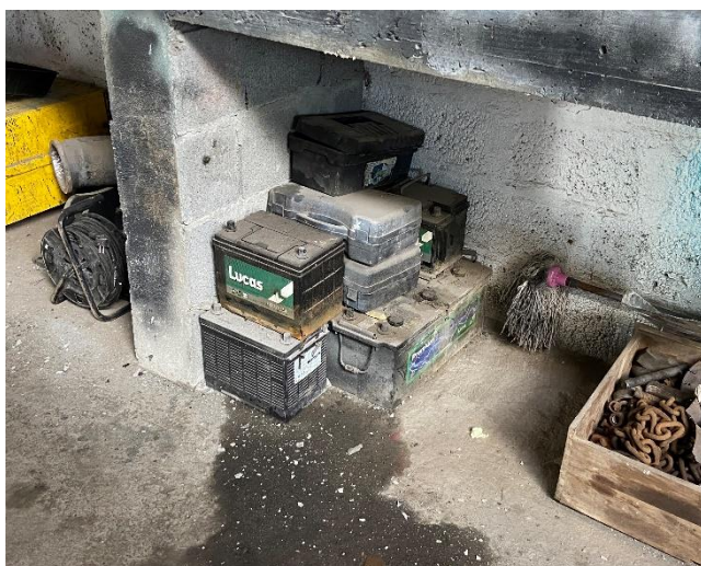
foto 7- Inadequada armazenagem de acumuladores.
