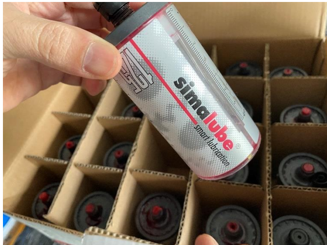
Foto 5 – Cartucho de lubrificação dos rotores.
