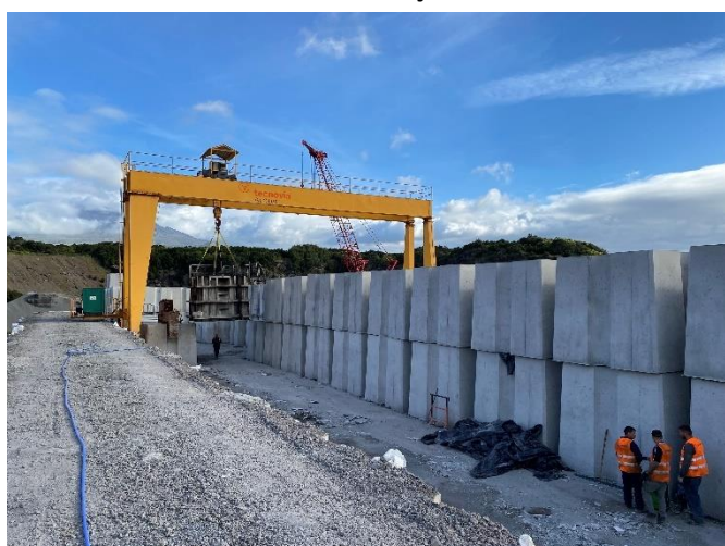
Foto 5 – Linha de fabricação de antiferes.
