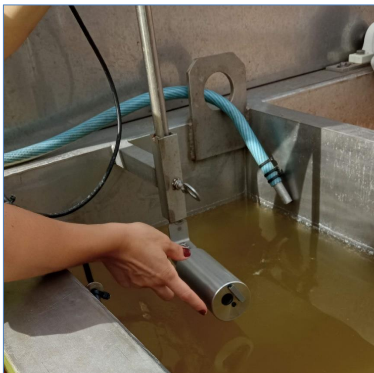
Figura 2.3: Detetor de turbidez.
