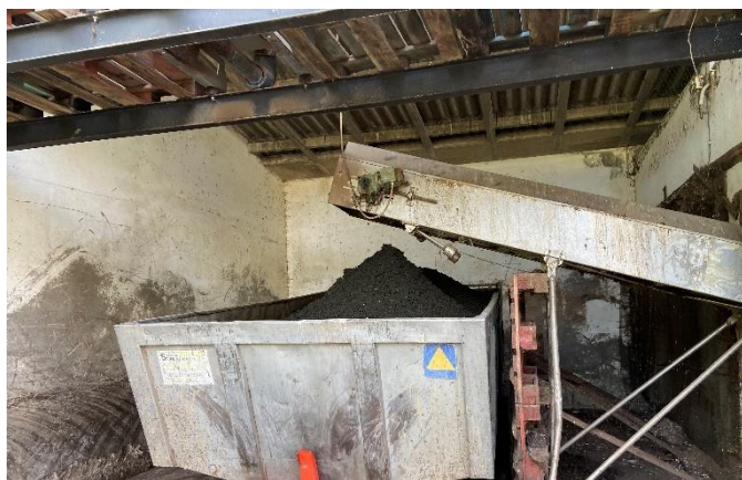
Foto 1 – Fase sólida segue para a vermicompostagem
