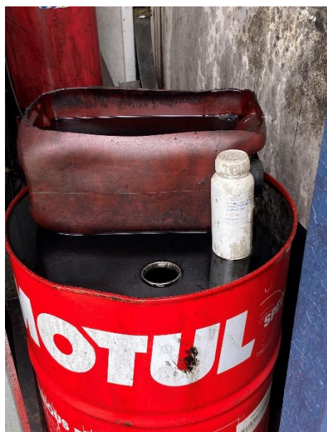
Foto 7 e foto 8 – Água oleosa resultante da contaminação do óleo usado com a água das chuvas e a bacia de retenção cheia.
