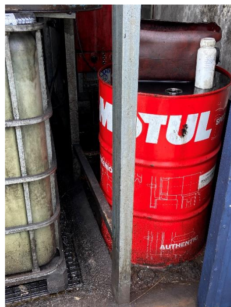
Foto 7 e foto 8 – Água oleosa resultante da contaminação do óleo usado com a água das chuvas e a bacia de retenção cheia.
