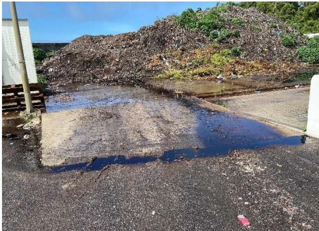
foto 5- Depósito de composto, com o líquido a escorrer para a rede de águas pluviais.
