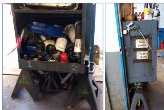
Figura 5.4: Local de descarga dos óleos usados (ligado por tubagem aos reservatórios).
