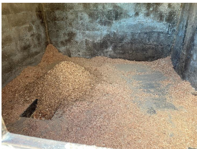
Foto 3 – Reservatório superior dos cavacos e serrim.
