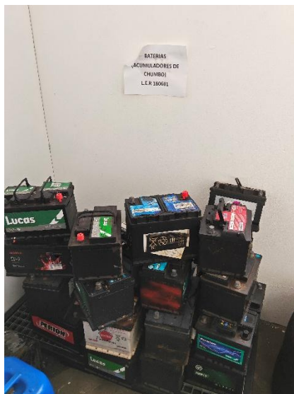
Foto 7 – Armazenagem de baterias sobre ripado de metal
